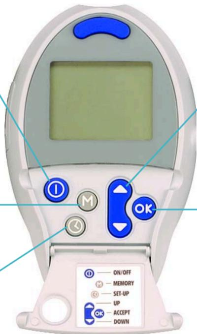
**Botones hacia arriba/abajo:** utilice estos botones junto con el botón de memoria para ver sus resultados o junto con el botón de configuración para cambiar la hora, la fecha, etc.
