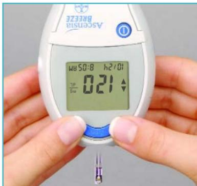
10. Presione el botón ① para apagar el medidor.
