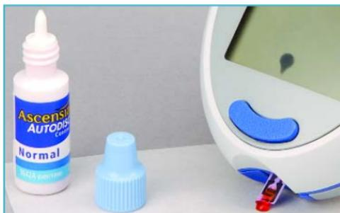
4. Mientras el medidor calcula el resultado del control, verá una secuencia de guiones en la pantalla. Transcurridos 30 segundos, el resultado de su prueba de control aparecerá en la pantalla. Compare el resultado de esta prueba de control con el rango impreso en la solapa inferior de la caja de tiras de prueba.
