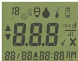
Una pantalla completa, tal como la que aparece aquí, indica que todos los caracteres de la pantalla funcionan adecuadamente. Para ver la pantalla completa, tire de la manija del medidor completamente hacia afuera. Compare la pantalla que aquí aparece con la de su medidor. Si hay alguna diferencia, consulte la sección de detección de averías de la página 40.
