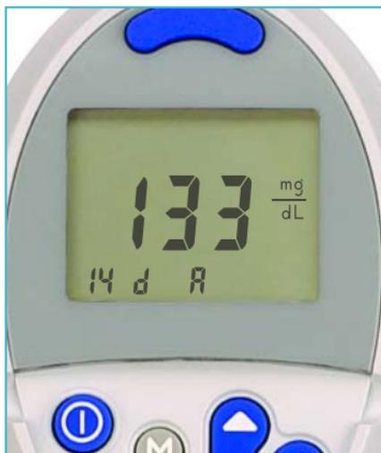
Puede volver a presionar el botón (M) para revisar los resultados de pruebas almacenados. **Nota:** Si no hay resultados en la memoria, el medidor mostrará tres guiones.
